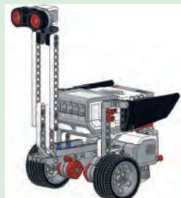
フォローイングダック センサーを使って何かを追いかけるロボット
